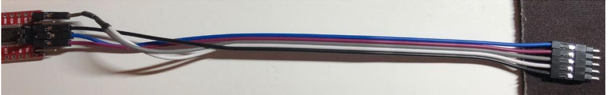
Ich habe also die Enden der grauen und weißen Leitung abgeschnitten und mit einem neuen Stecker zusammengelötet. Nun wird dieses Ende auf den GND Pin am Konverter gesteckt und somit sind die PINS GND und GPIOO an der Dose gebrückt und beide mit GND verbunden. Falls man gar nicht löten kann, funktioniert es sicher auch die enden ab zu isolieren und zu verdrillen.
