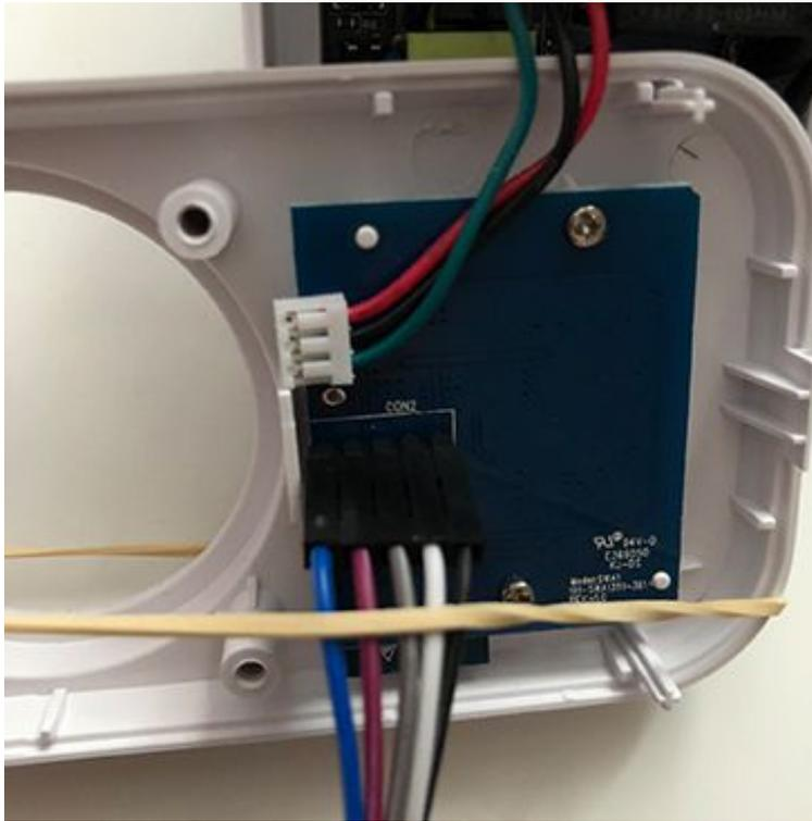
Hier kommt es nun auf die persönliche Vorliebe an. Entweder Stiftleiste einlöten und Kabel stecken oder Stiftleiste in am Ende der Leitung einstecken und das ganze mit einem Gummi oder mit den Fingern an der Steckdose fixieren.
