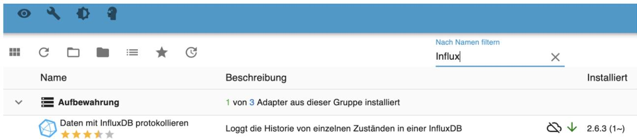
Zur Anbindung von *ioBroker* an eine *InfluxDB* Datenbank wird der Adapter *Influxdb* benötigt.
