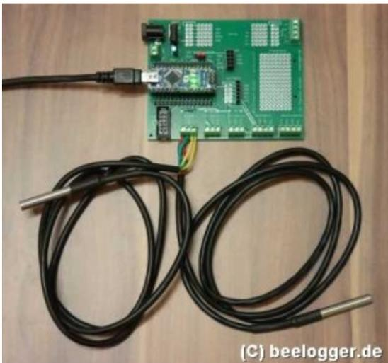
Der Programmcode enthält neben einer Abfrage der angeschlossenen Sensoren eine zusätzliche Prüfung beim Auslesen den Sensoren auf mögliche Verbindungsfehler. Tritt ein Problem auf, beispielsweise durch ein loses Kabel, bekommt die entsprechende Variable für Temperatur einen vordefinierten Wert. Mit diesem Test-Programmcode wird zusätzlich eine Fehlermeldung über den seriellen Monitor ausgegeben.
